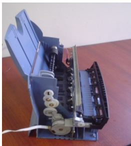
Fig.6. Mecanismo utilizado para almacenamiento y alimentación de las hojas
