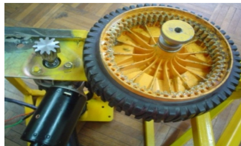
Fig.4. Relación de engranajes entre eje del motor y la llanta
