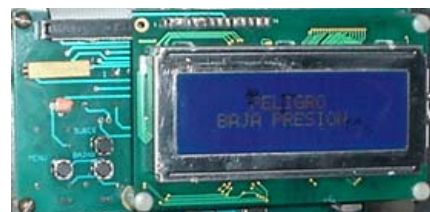
Figura 15 Prueba de baja presión
