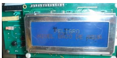
Figura 16 Prueba del sensor de nivel
